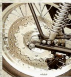
Transporter: Die Heckfederbeine wandern in die Heddingham-Gabel, hinten dämpfen nun Hagen-Elemente
